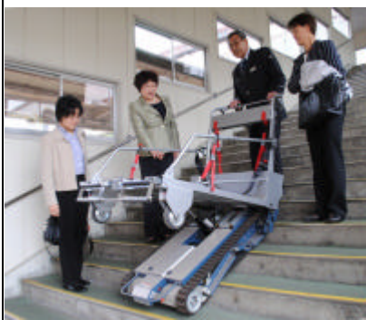
駅に設置されている車いす用階段昇降機（リフター）
